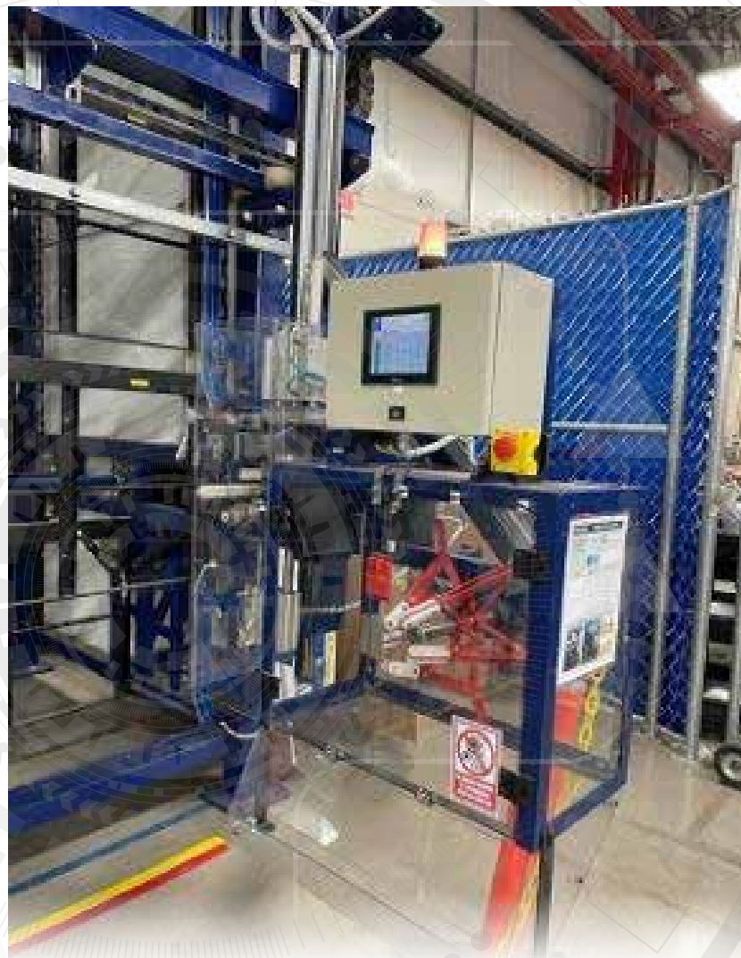
Sistema automático de medición y corte de fundas Latelec
