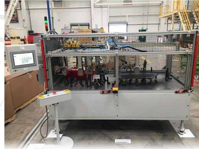
Equipo de engrapado automático con equipo Mezger Planta Autoneum San Luis Potosí
