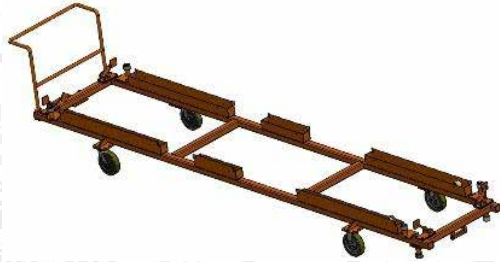
Paint Skid Dolly, barge cars para procesar partes de reemplazo y cachoras para transporte de unidades en proceso y reparación
