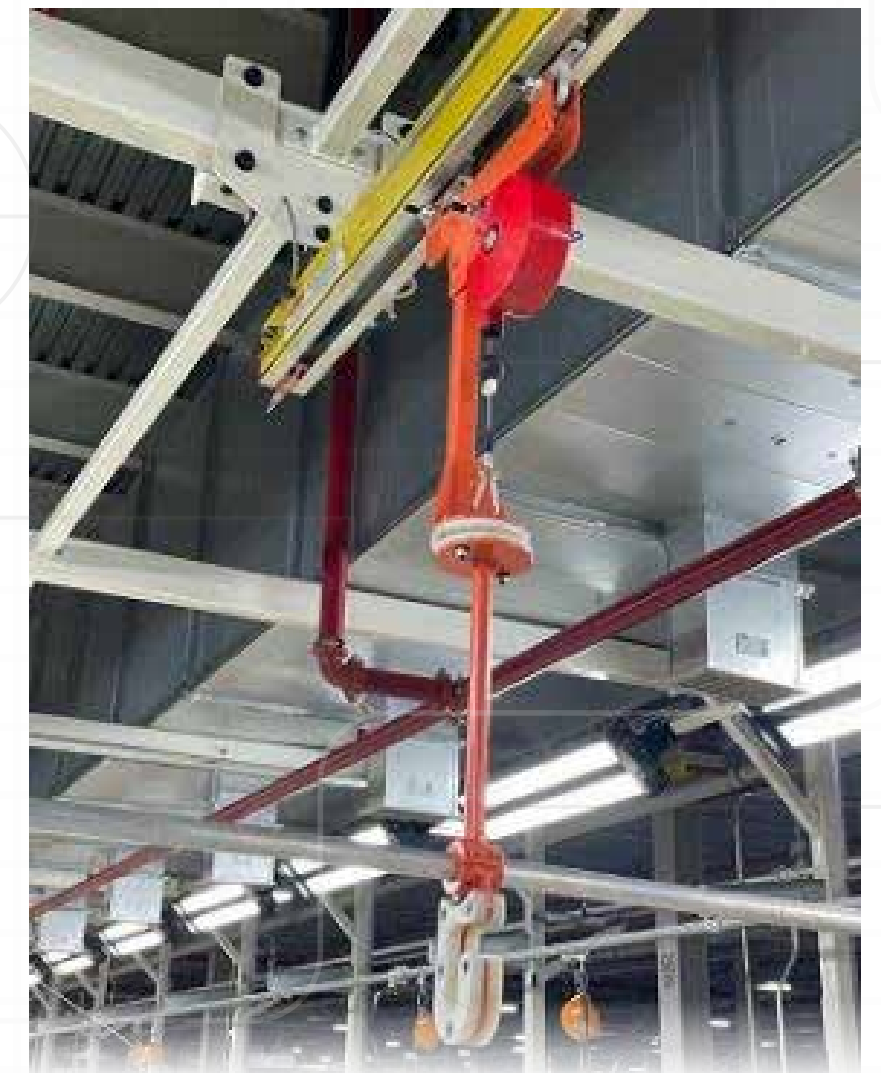
Asistente de carga de cofres Ford Bronco y Maverick
