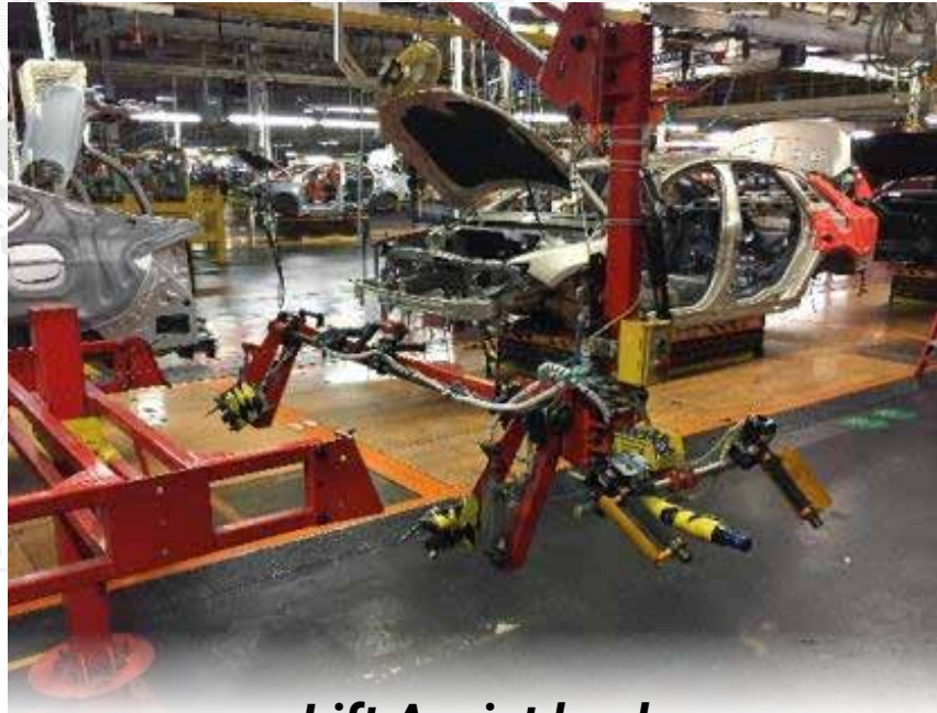
Lift Assist back up para instalación de tablero IP
