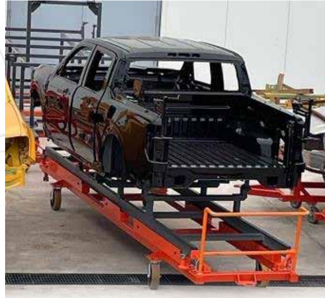
Paint Skid Dolly, barge cars para procesar partes de reemplazo y cachoras para transporte de unidades en proceso y reparación
