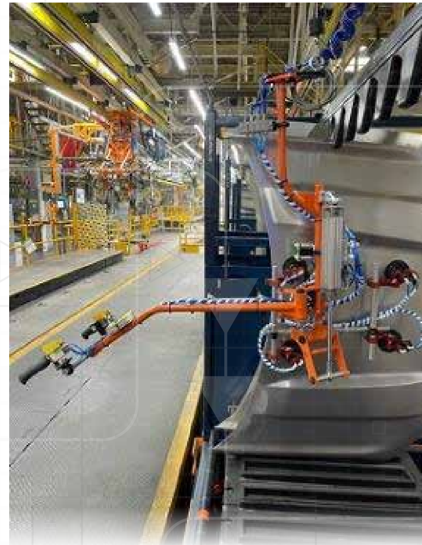
Lift Assist para instalación de cofre unidades Ford Bronco Sport y Maverick
