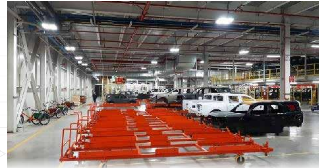
Paint Skid Dolly, barge cars para procesar partes de reemplazo y cachoras para transporte de unidades en proceso y reparación
