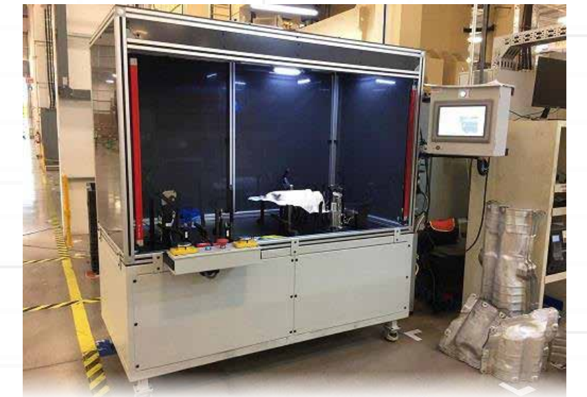
Equipo pokayoke de presencia de clips en heat shield con sistema de visión
