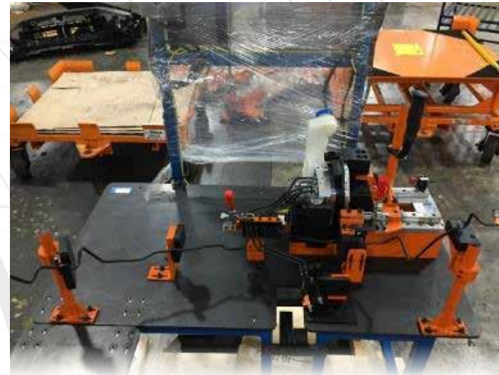
Estación de trabajo para ensamble de modulo EBB unidades Ford Bronco y Maverick
