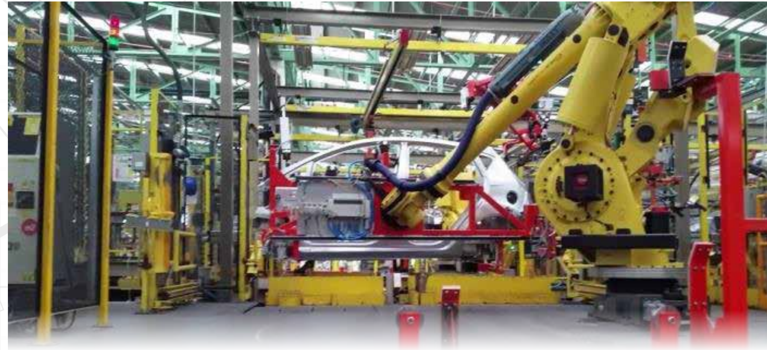
End Effector y Fixture geométrico para instalación de Body Side
